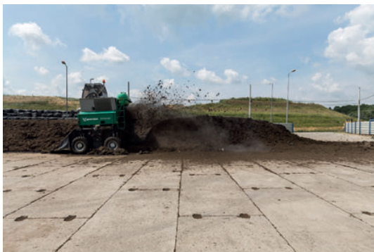
Przewracanie kompostu z odpadów zielonych w celu jego napowietrzenia i pobudzenia do działania bakterii termofilnych Zdjęcia MPO Kraków
